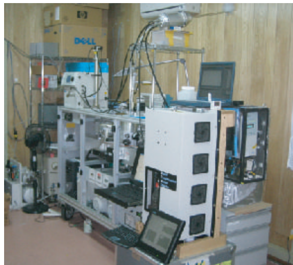
写真：辺戸岬に設置し観測中のエアロゾル飛行時 間質量分析装置(ATOFMS)
