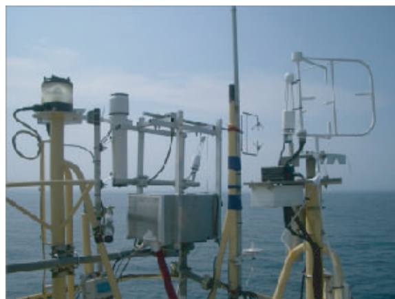
写真：船上に設置した渦相関法フラックス測定システムの一例
